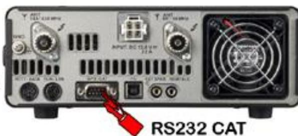
Branchez le câble fourni dans le port RS232 Cat de l'émetteur-récepteur. Branchez l'autre se terminer dans les CatMeters
